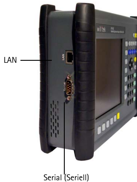
Abbildung 2 9102 Verbinder auf der linken Seite des Gerätes
